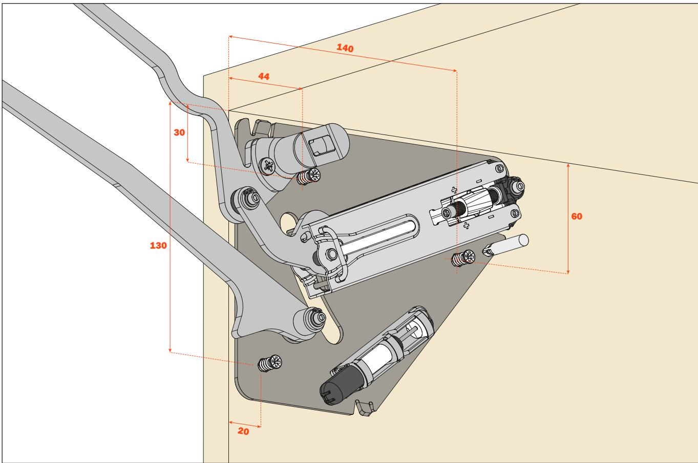
Montaggio dell'anta sul mobile.
